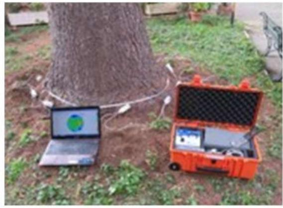
misurazione ( $R$ ) è inferiore a 0.3 si ha statisticamente una possibile probabilità di rottura dell'albero, di conseguenza si dovrà abbattere l'albero. Per piante potate il fattore  $t/R$  è 0.2. In molti casi si possono utilizzare delle tecniche di consolidamento che permettono di conservare esemplari arborei riducendone la pericolosità.
